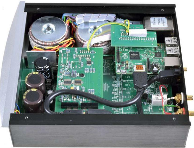
Innen ist der CAAS ebenso highendig wie außen: zwei Ringkerntrafos, getrennt für den Analog- und den Digitalteil, und eine ganze Armada von Netzteilenelementen im Untergeschoss der Platine. Unten rechts die highendigen Analog-Ausgänge, einzig die interne Umsetzung der HDMI-Signale hat eindeutig Kleinseriencharme.
