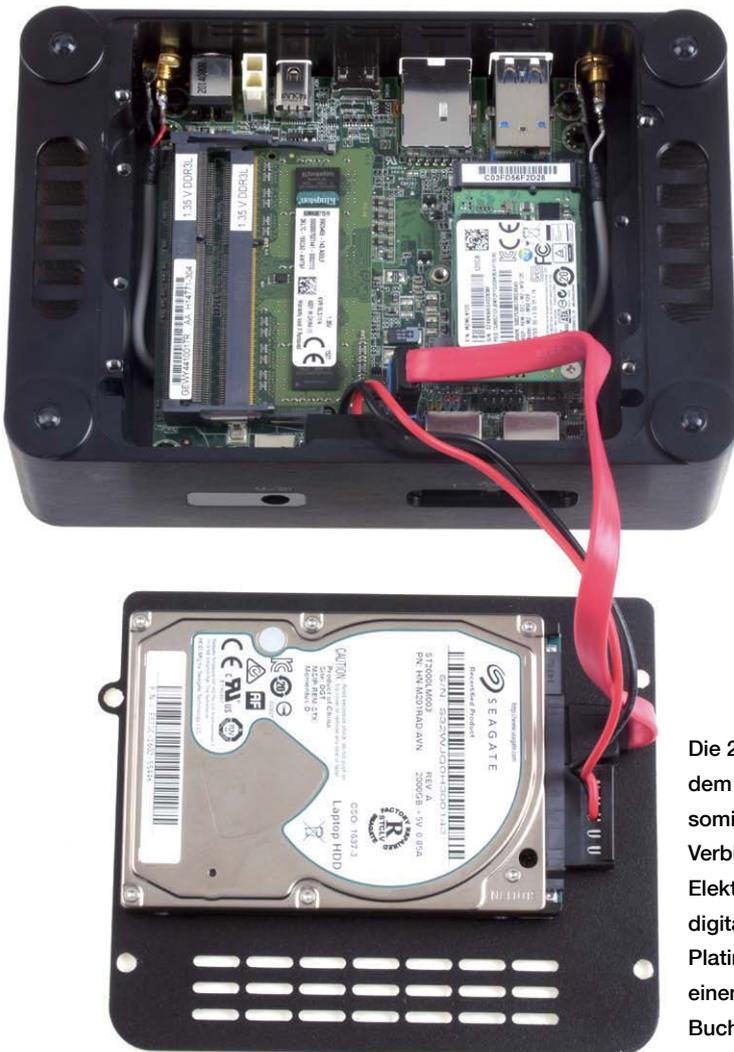
Die 2 TByte große Festplatte sitzt auf dem Boden des Alu-Gehäuses und hat somit keine direkte mechanische Verbindung zur dicht gepackten Elektronik-Platine. Während die digitalen Anschlüsse direkt auf der Platine sitzen, muss das Analogsignal einen relativ weiten Kabelweg zu den Buchsen zurücklegen.
