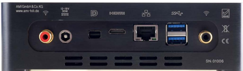
„WLAN“-Symbole plus orangerote und schwarze Farbcodierung für die an beiden äußeren Enden der Rückseite sitzenden Cinch-Buchsen. Ein Schelm ist, wer dahinter Digital-Anschlüsse und nicht die Analog-Ausgänge für den linken und rechten Kanal erwartet. Statt S/PDIF gibt es HDMI.
