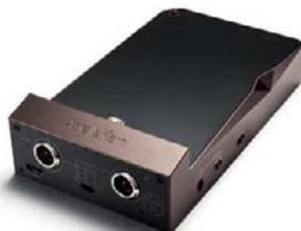
Mikrofon-Set von Danish Professional Audio an. Für den Anschluss solcher Kondensator-Mikrofone dienen zwei Mini-XLR-Eingänge mit zuschaltbarer Phantomspeisung von 5 oder 48 Volt. Durch Umschalten wird daraus ein symmetrischer Stereo-Hochpegel-Analogeingang. An der Seite sitzt noch ein zweiter Stereo-Analog-Eingang mit 3,5-mm-Klinkenbuchse. Wer seine Vinyl-Sammlung
